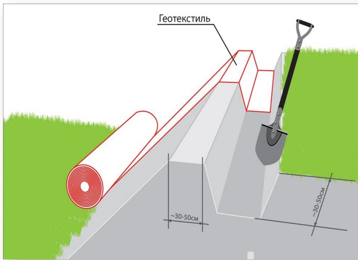
5. Для укладки подстилающего слоя распакованный нетканый геотекстиль «Геофлакс» расправляется и укладывается по направлению ведения последующих полотен геомембраны.
